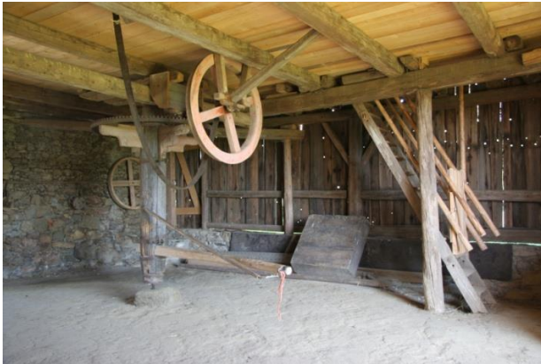
Scheune samt Göpelhütte, Göpel diente als Antriebskraft für verschiedene Maschinen
